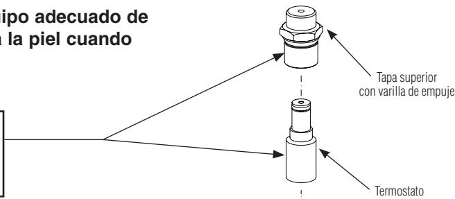
**B** Inserte una varilla de 8 mm de diámetro en la válvula hasta que toque la parte superior de la varilla de empuje que está adherida al pistón. Marque la longitud de la varilla dentro de la válvula. Empuje la varilla hasta que se detenga el pistón y marque la nueva longitud.
