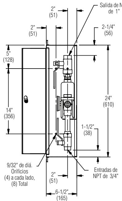
**Orificio de la pared:** 62 cm (24-1/2 pulg.) de ancho x 62 cm (24-1/2 pulg.) de alto
