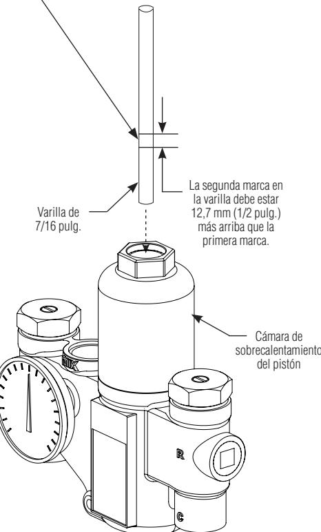
**D** Empuje el mecanismo hacia arriba y hacia abajo varias veces para asegurarse de que el pistón se mueva suave y constantemente. Si es constante, repita el Procedimiento C hasta que se mueva libremente o cámbielo. Comuníquese con el representante local de Bradley y consulte por el Kit del pistón y revestimientos (número de pieza S65-489).
