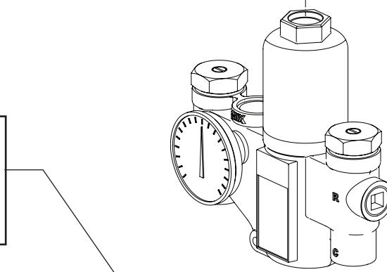
Si la varilla se desplaza menos de 12,7 mm (1/2 pulg.), el pistón no se mueve libremente dentro del revestimiento y se deben limpiar:
