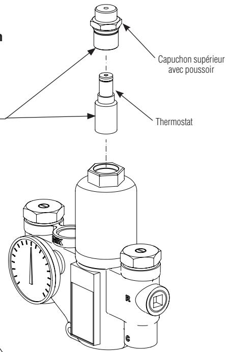
**B** Insérer une tige de 7/16" de diamètre dans la valve jusqu'à ce qu'elle touche le haut du poussoir attaché au piston. Marquer la longueur de la tige à l'intérieur du robinet. Pousser la tige jusqu'à ce que le piston arrête et marquer la nouvelle longueur.
